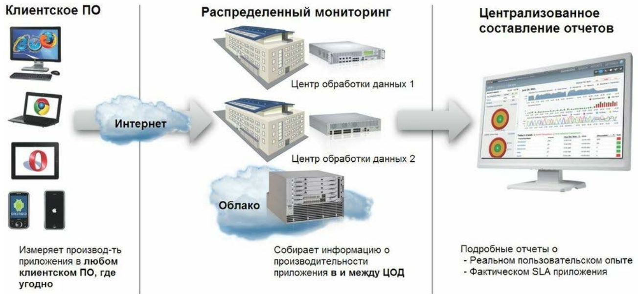
Рисунок 5: Методология Radware для измерения производительности приложений
